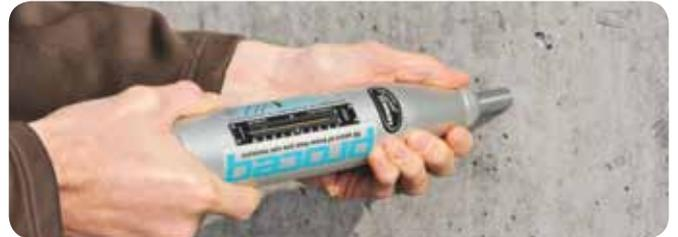
**N/L 型：**用作所有回弹仪与之进行比较的基准，以及每项国际性回弹仪标准的基础。该产品具有不同的冲击能量，允许客户测试多种类型的材料和结构。
