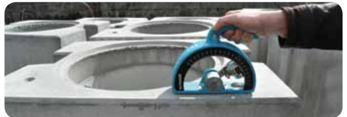
**PT 型：**这一产品配有大型冲击锤表面，特别适用于对软性材料进行测试，如轻质混凝土、灰泥板和新拌混凝土。它通常用于确定取走模板的恰当时间。
