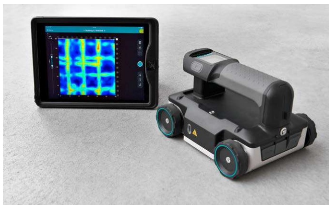
Proceq GPR 掃描四輪載具以無線方式連接到 iPad
