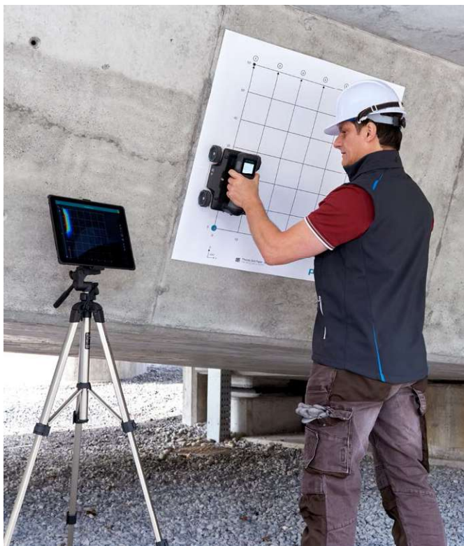
Proceq GPR Live 在 Proceq 網格紙的幫助下執行面積掃描
